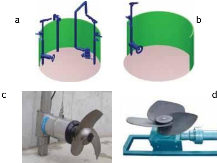
Şəkil 36. Mexanik gübrə qarışdırıcılar a-mexaniki qarışdırıcı+nasos kombinasiyası b-mikser c-dalma mikser d-pərli qarışdırıcı
